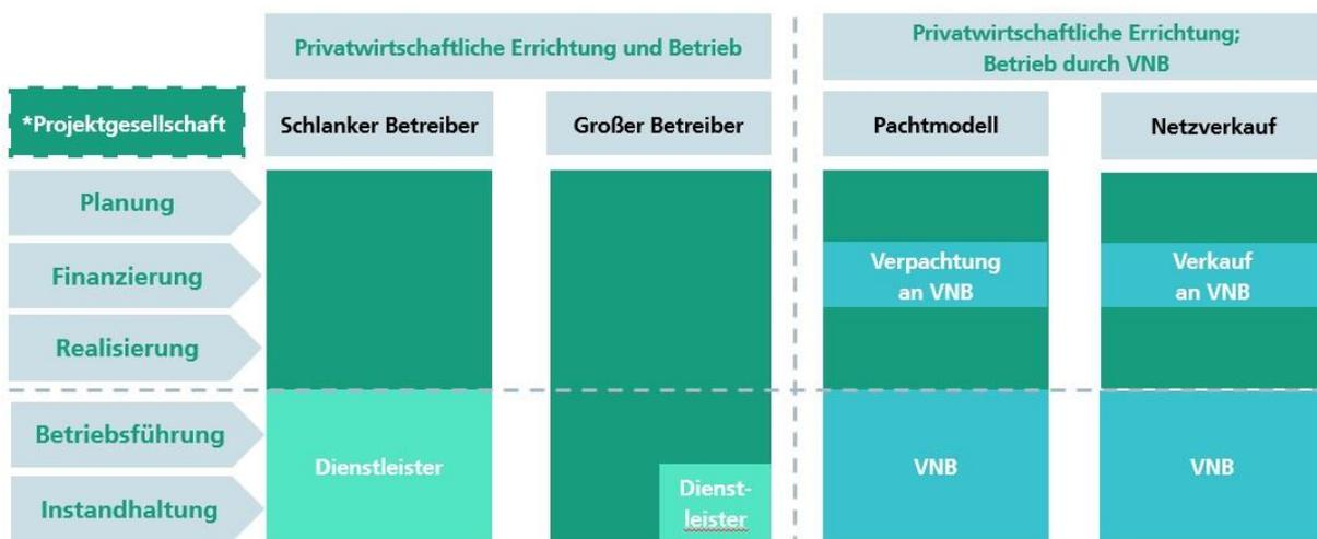
Abbildung 24: Mögliche Betreibermodelle für ein Einspeisenetz
